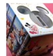
传统的胶窗要求薄膜粘合工艺要与糊盒工艺离线进行。现代的先进技术可以让胶窗操作在糊盒胶粘机上在线进行。汉高针对这种工艺专门开发了一种粘合剂，这种粘合剂也适合用于传统的胶窗机器。这种从离线到在线粘合的改变可以让折叠纸箱的生产商提高其产量、提高效率，并将产品处理过程降到最低。
